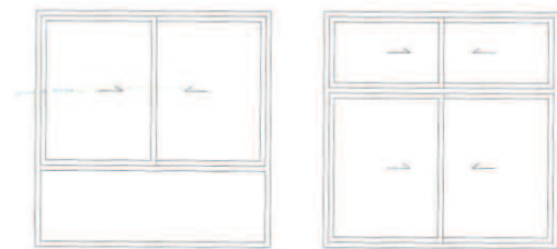
图1 横中挺直接承受窗扇重量的窗型
