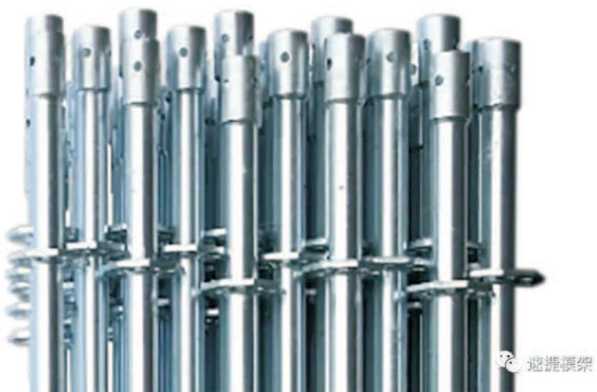
套筒作为限制立杆位移，保证上下立杆传力均匀的部件，在《承插型盘扣式钢管支架构件》JG/T503-2016标准中有如下规定，这条规定分别对应了3种套筒形式：1、内插管 2、内壁有台阶的外套筒 3、内壁无台阶的外套筒。这3种形式，最大的区别在于上下立杆的传力方式。
