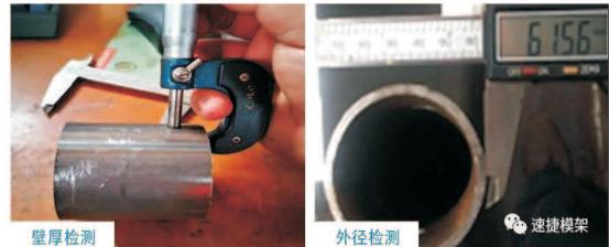
当然，钢管的外径、壁厚数值越大，其承载力越高。但是过大的承载力，远高于实际的施工需求，反而降低了脚手架承载力的利用率。而增加的外径和壁厚只会降低搭设效率，提高业主投入成本。
