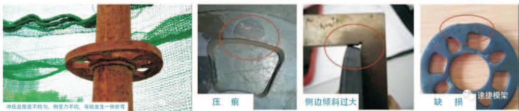
我们都知道，在金属板被切开后，其断面会出现不同程度的收缩形成一定弧面，在焊接时一些特定形状的断面还会严重影响焊接质量。例如中间凹陷两端或者一端紧贴钢管，在焊接时熔液无法顺利流入内部，产生内部缺陷。
