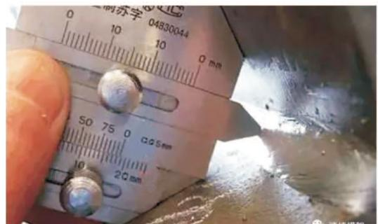
焊接测量尺还能测量如咬边深度、焊缝宽度、焊件坡口角度等等，小编在这里就不一一介绍了。
