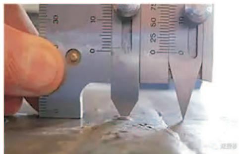
测量角焊高度：用该尺的工作面靠紧焊件和焊缝，并滑动高度尺与焊件的另一边接触，看高度尺的指示线，指示值即为焊缝高度。
