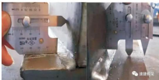
**测量角焊缝：**在 $45^{\circ}$ 时的焊点为角焊缝厚度。首先把主体的工作面与焊件靠紧，并滑动高度尺与焊点接触，高度尺所指示值即为焊缝厚度
