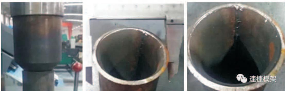
在室温下，通过用60° 锥度的压头，以20-50mm/min的速度匀速下压，使钢管口径扩大到原来的115%。此时样件内外部不应出现明显裂纹或损坏，焊缝没有开裂或焊料脱离。
