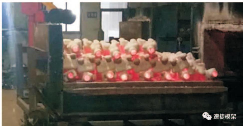
**覆膜砂铸造：**将石英砂加热后放入混砂机，加入树脂、固化剂、防结剂，使石英砂表面覆一层树脂膜，混制均匀后放出冷却破碎备用，使用时需加热固化。
