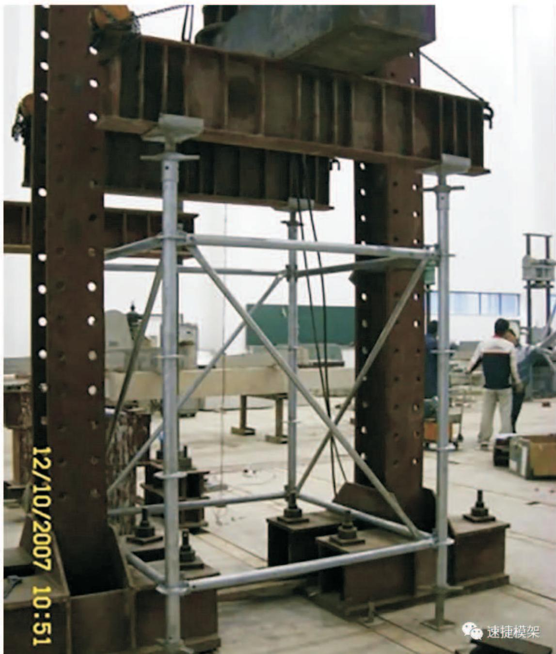
结合规范计算得出的结果，江苏速捷模架科技有限公司联合东南大学，对盘扣架做了一系列的科学的系统的承载力试验。
