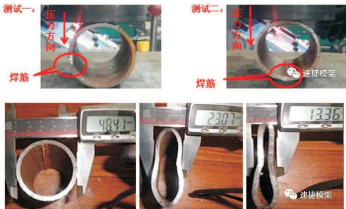
在室温下，使用压力机，分别对焊缝垂直于压力方向（测试一）和平行于压力方向（测试二）的两组样件，以20-50mm/min的速度下压，直至样件外径达到原外径的2/3（垂直于压力方向）和1/3（平行于压力方向）时停止。此时样件上不应出现明显裂纹或层状结构或损坏，焊缝没有开裂或焊料脱离。
